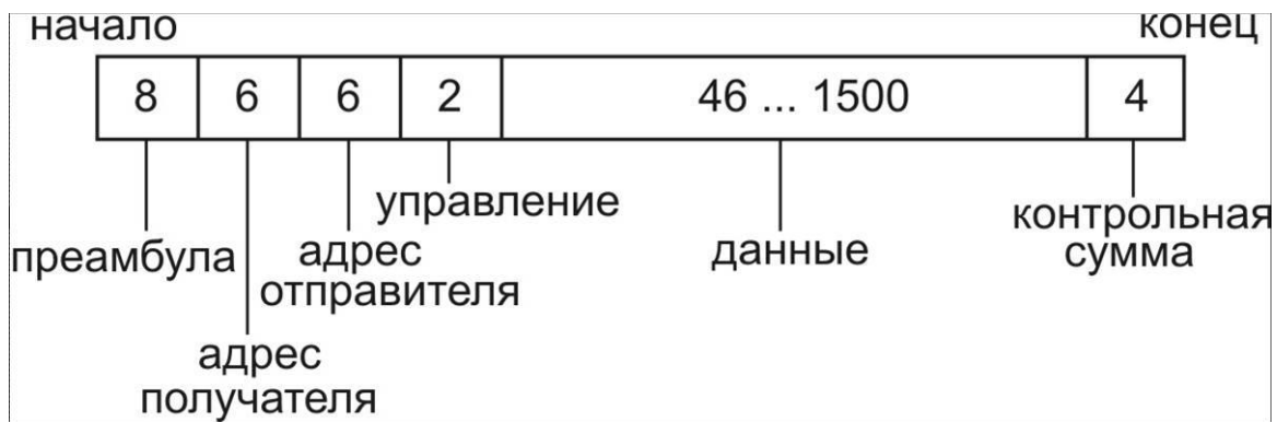
Рис. 53. Формат пакета Ethernet
